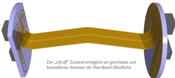
Der „Lift-off“ Zustand ermöglicht ein gerichtetes und kontrolliertes Verlassen der Flexi-Board-Oberfläche
